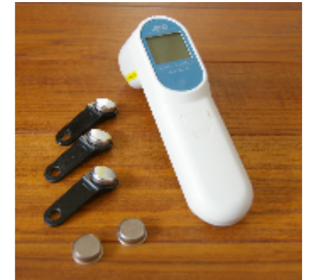
計測に用いるボタン電池大のデータロガーと放射温度計
